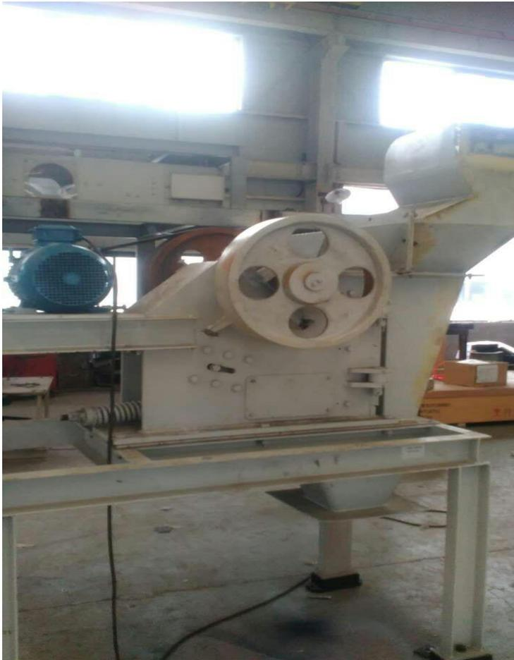
名称：碎煤机；转速：450rpm；功率：7.5KW
