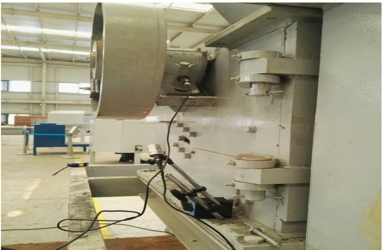
在碎煤机轴承座上测量振动
