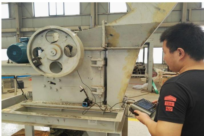
1)、先用 BVM-100-2D 做现场动平衡的初始测试, 测得:
